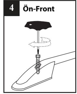
**2)Port Bagajı araç üzerine montaj yerlerinden sabitleyip 1,2,3,4 nolu civatalar sıra ile yaklaşık 5 Nm sıkılıp araç üzerinde merkezleyiniz sonrasında yine sıra ile sıkma kuvveti 10 Nm çıkarınız.**
